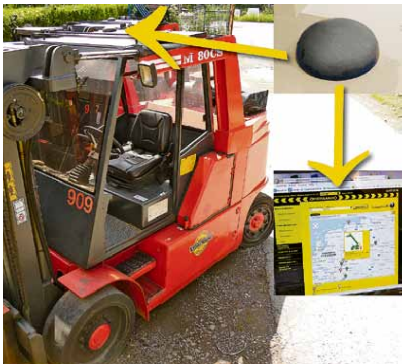
Durch diesen kleinen runden Kasten des Rösler Obserwando-Systems können Maschinen geortet und gesichert und Daten übertragen werden. Auf dem Bildschirm in der Zentrale erscheinen dann in der Obserwando-Maske die gewünschten Daten.
